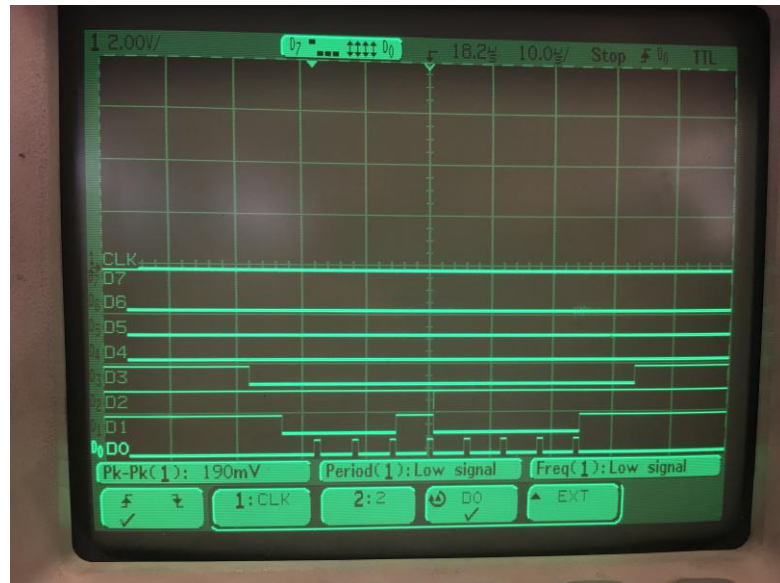
(D) Logic Analyzer on Agilent Oscilloscope with SPI clock, MISO, MOSI and CS data
